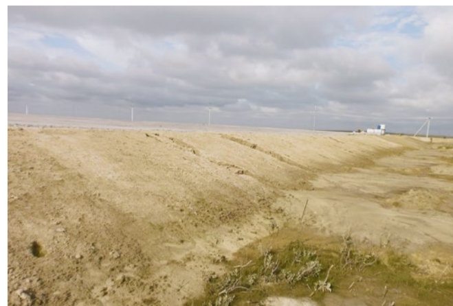
Контрольный необработанный участок откоса после дождя
