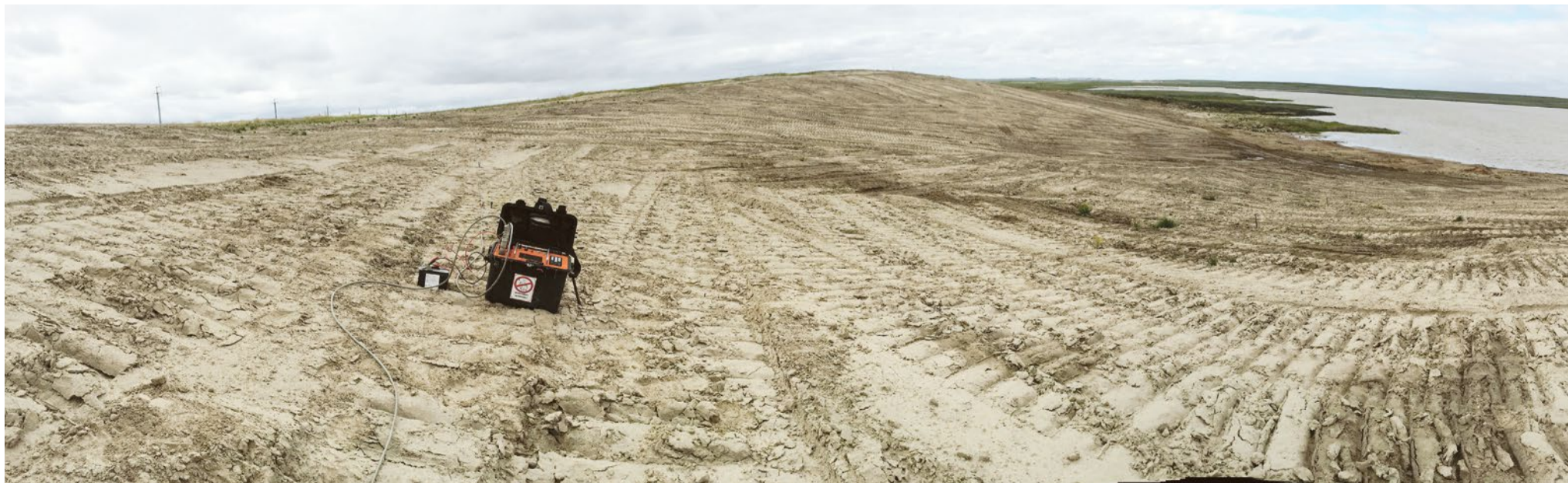
Электротомография на рекультивированном участке овражной эрозии
