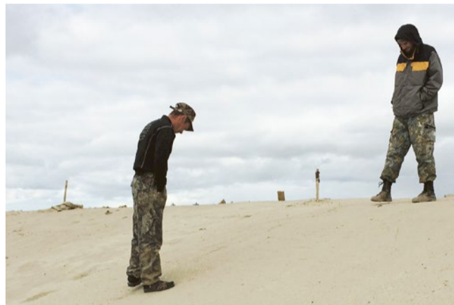
Обработанный участок откоса выдерживает вес человека
