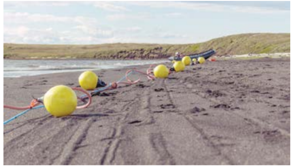
Детальная электротомография позволяет нарисовать границы мерзлоты
