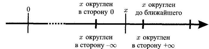
Рис. 10.1. Четыре способа округления, определенные стандартом IEEE 754
