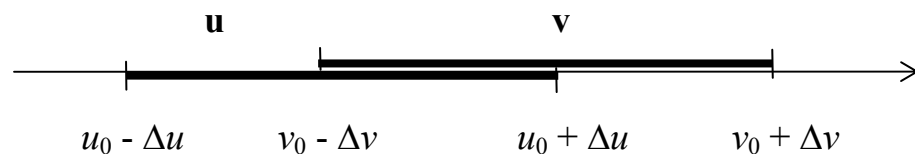
Рис. Изображены пересекающиеся интервалы \mathbf{u}, \mathbf{v} на числовой прямой. Точки u, v этих интервалов удовлетворяют неравенству u \leq v , если принадлежат соответствующим отрезкам [u_0 - \Delta u, v_0 - \Delta v] и [u_0 + \Delta u, v_0 + \Delta v] . Отношение общей длины данных отрезков к общей длине интервалов \mathbf{u}, \mathbf{v} с точностью до знака совпадает с показателем (3.4)
