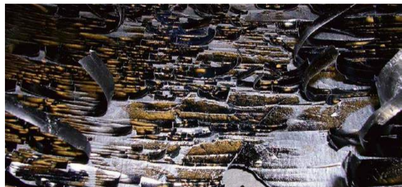
Лист вольфрама после многократного облучения плазменным потоком в выходном узле многопробочной ловушки ГОЛ-3
