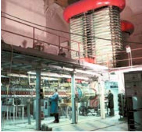
ГОЛ-3 — установка открытого типа с гофрированным магнитным полем для нагрева и удержания горячей плазмы, созданная в ИЯФ СО АН СССР
