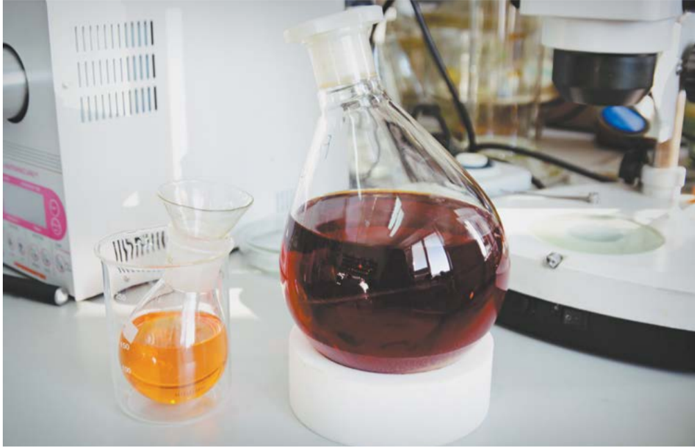
Растворы перспективных рентгеноконтрастных препаратов на основе кластерных комплексов вольфрама (слева) и молибдена (справа)
