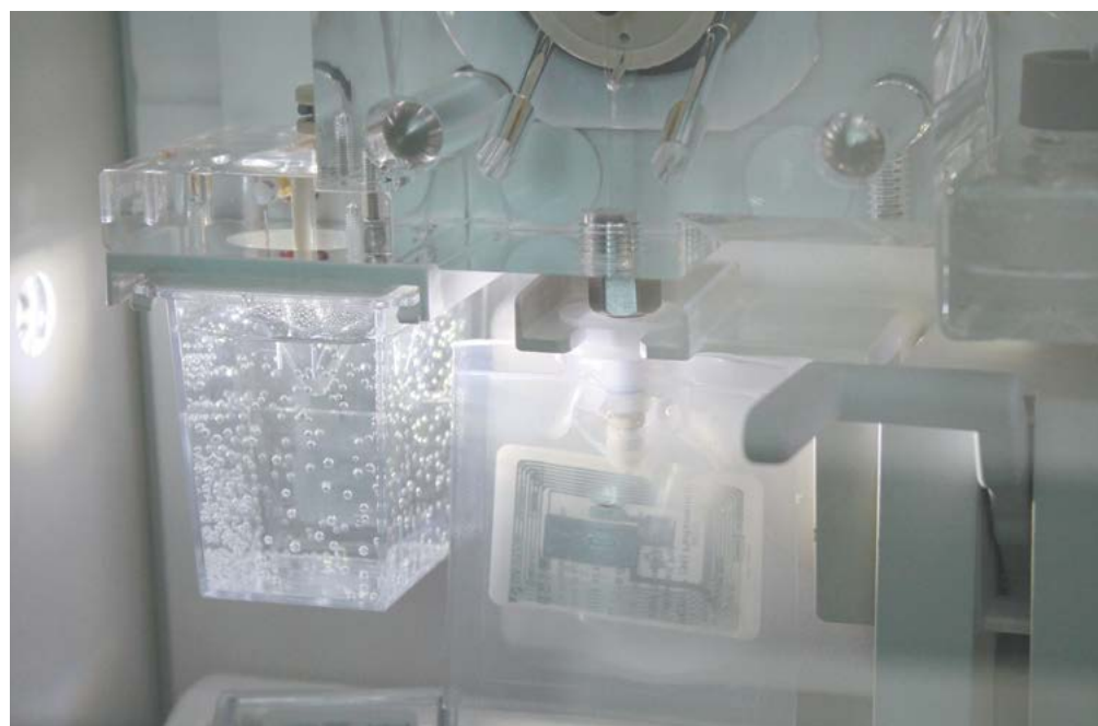
Внутреннее устройство капиллярного секвенатора
