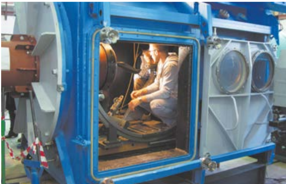
Гиперзвуковая аэродинамическая труба адиабатического сжатия АТ-303, ИТПМ СО РАН
