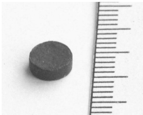
Фотография спека кубического нитрида кремния (цена маленького деления — 1 мм).
