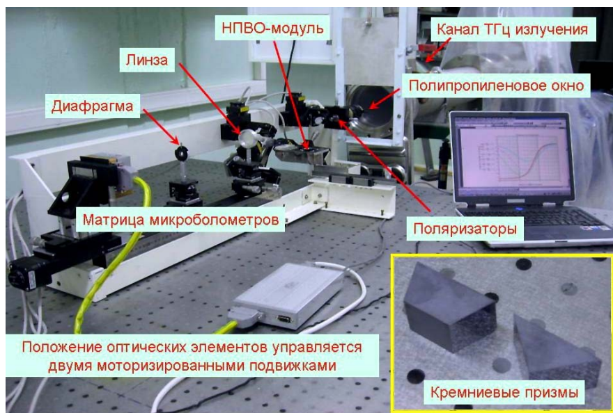
Рис. 59. Общий вид спектрометра нарушенного полного внутреннего отражения с кремниевыми призмами.
