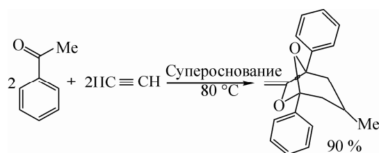
Рис. 10. Однореакторная стереоспецифическая сборка аналогов фронталина (7-метилена-6,8-диоксабицикло[3.2.1]октанов) из кетонов и ацетилена.
