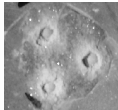
Рис. 26. Критерий наиболее разрушительного действия ударных импульсов (возникновения волн маятникового типа) и картина объемного разрушения гранита.
