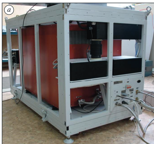
Рис. 34. Внешний вид лазерной системы на несущей раме (а) и энергия выходного излучения (б).
