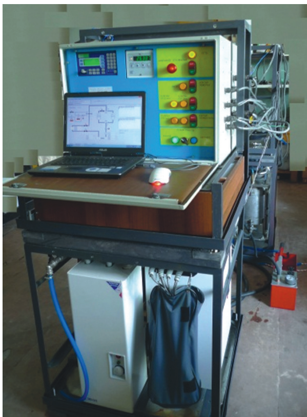
Рис. 10. Внешний вид установки для проверки поточных вискозиметров.
