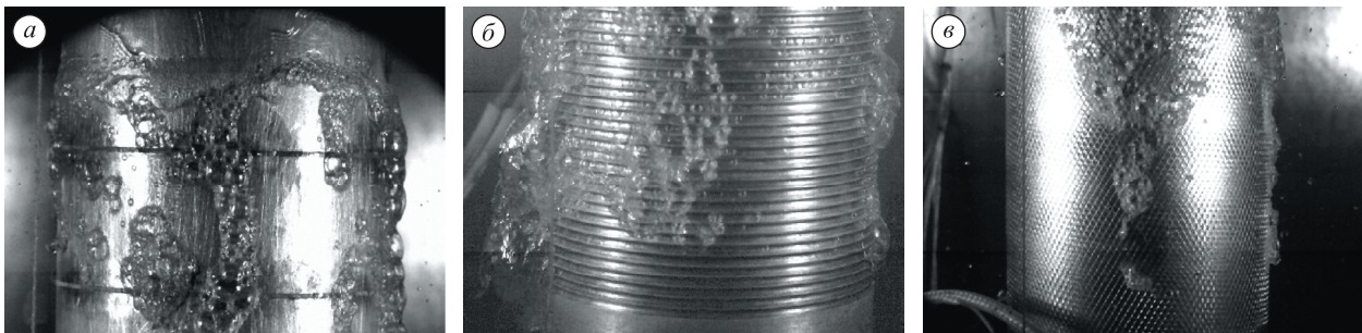
Рис. 15. Развитие кризиса на гладкой (а) и структурированных (б, в) поверхностях.
