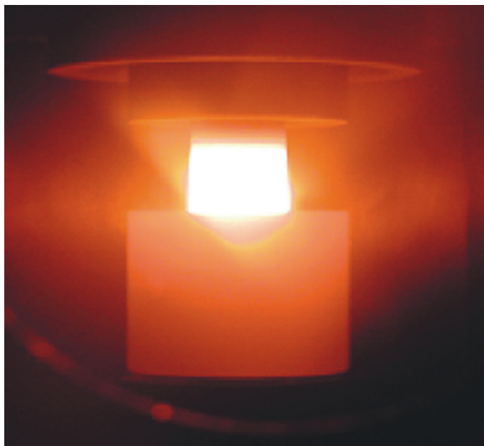
Рис. 50. Нагрев образца, спекаемого в установке Labox 1575.
