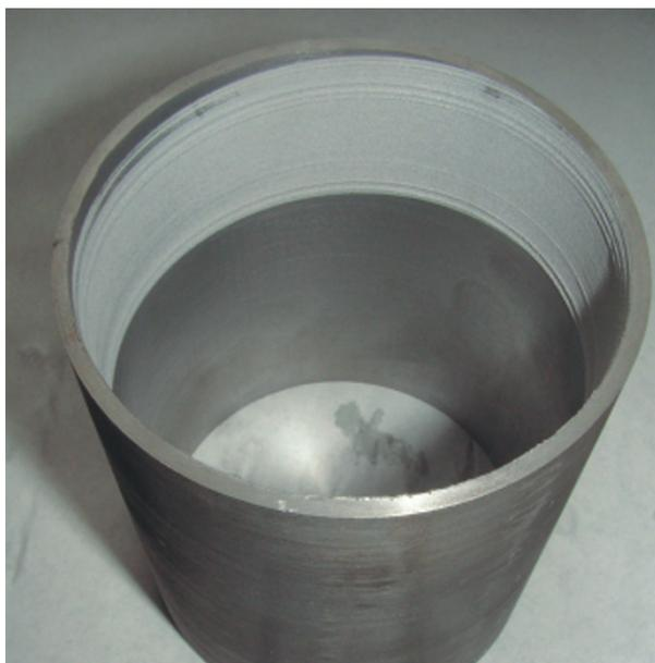
**Рис. 73.** Образец трубы с внутренним диаметром 80 мм с покрытием из алюминия.
