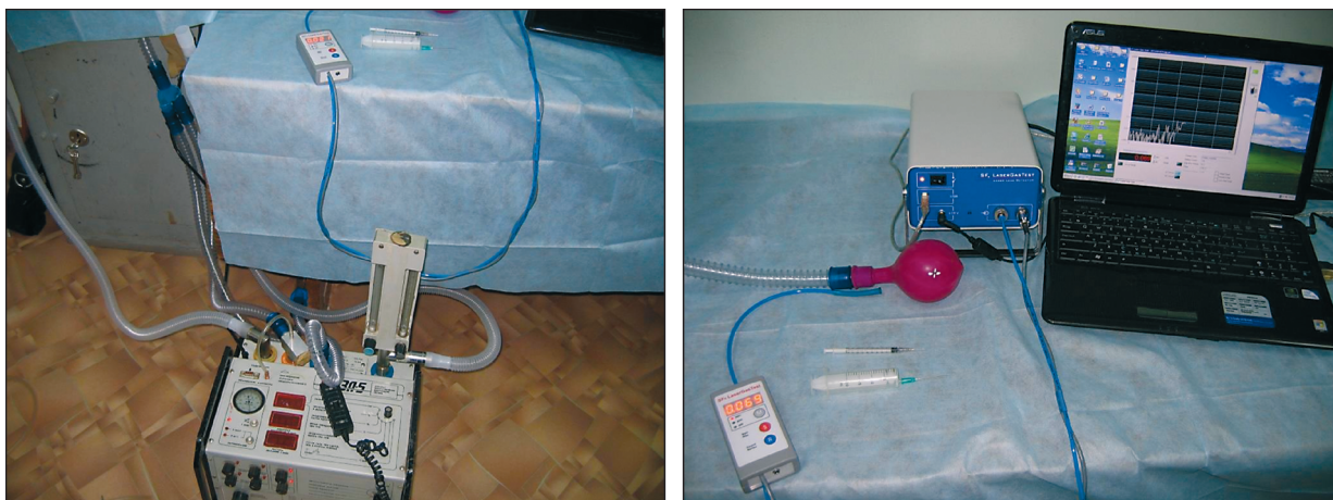
Рис. 31. Аппарат искусственной вентиляции легких «ФАЗА 5» (слева), лазерный оптико-акустический теческатель «LaserGasTest» и имитация дыхательной системы резиновым шариком (справа).
