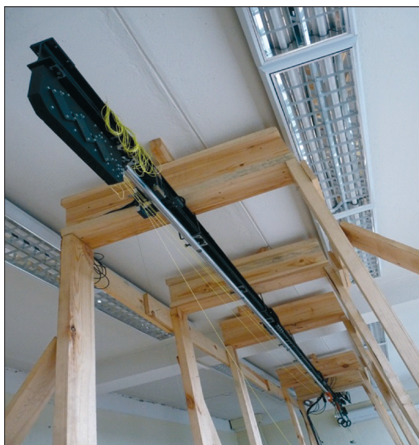
Рис. 27. Внешний вид элемента активной системы обезвешивания раскрытия КТС (в системе 12 таких элементов).
