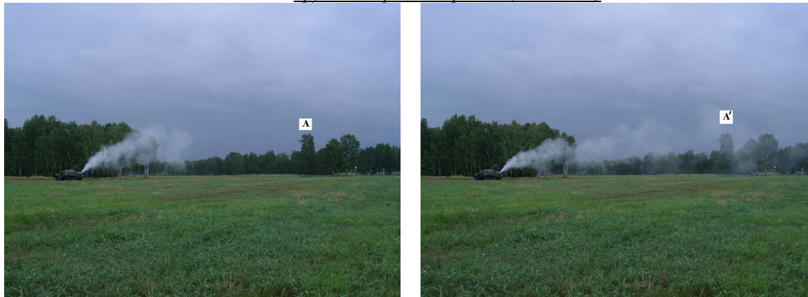
Рис. 2. Изменение формы дымовой струи в зависимости от метеоусловий и размера аэрозольных частиц.
