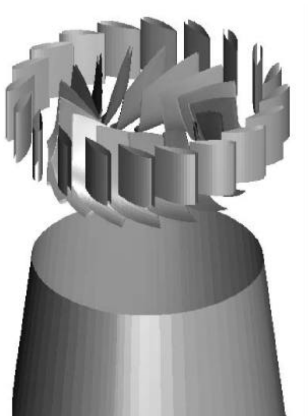
Рис. 7. Лопатки направляющего аппарата и лопасти рабочего колеса.
